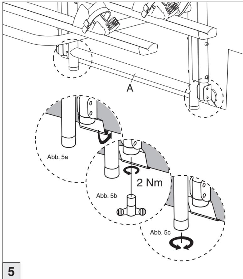
5. Öffnen Sie die beiden unteren Haltekrallen mit dem Vielzahnsschlüssel. Öffnen Sie die Heckklappe leicht und haken Sie die unteren Haltekrallen am Falz der Heckklappenunterkante ein (Abb.5a).
