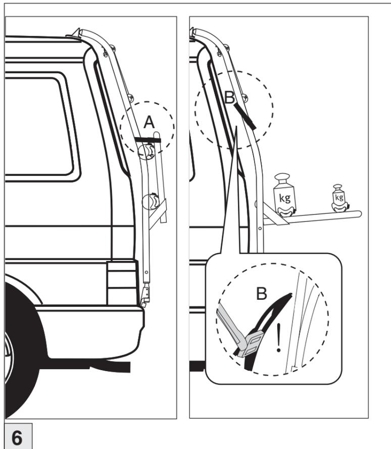
6. Wenn kein Fahrrad transportiert wird, klappen Sie den Ausleger hoch und sichern Sie ihn mit dem Spanngurt am Basisrahmen (A).
