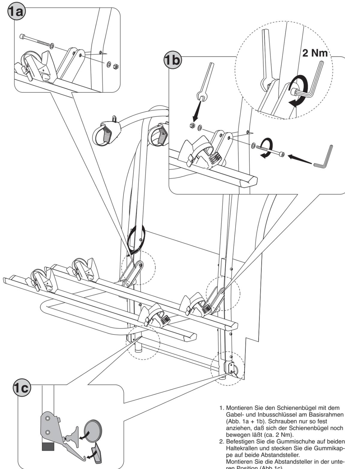
1. Montieren Sie den Schienenbügel mit dem Gabel- und Inbusschlüssel am Basisrahmen (Abb. 1a + 1b). Schrauben nur so fest anziehen, daß sich der Schienenbügel noch bewegen läßt (ca. 2 Nm).
