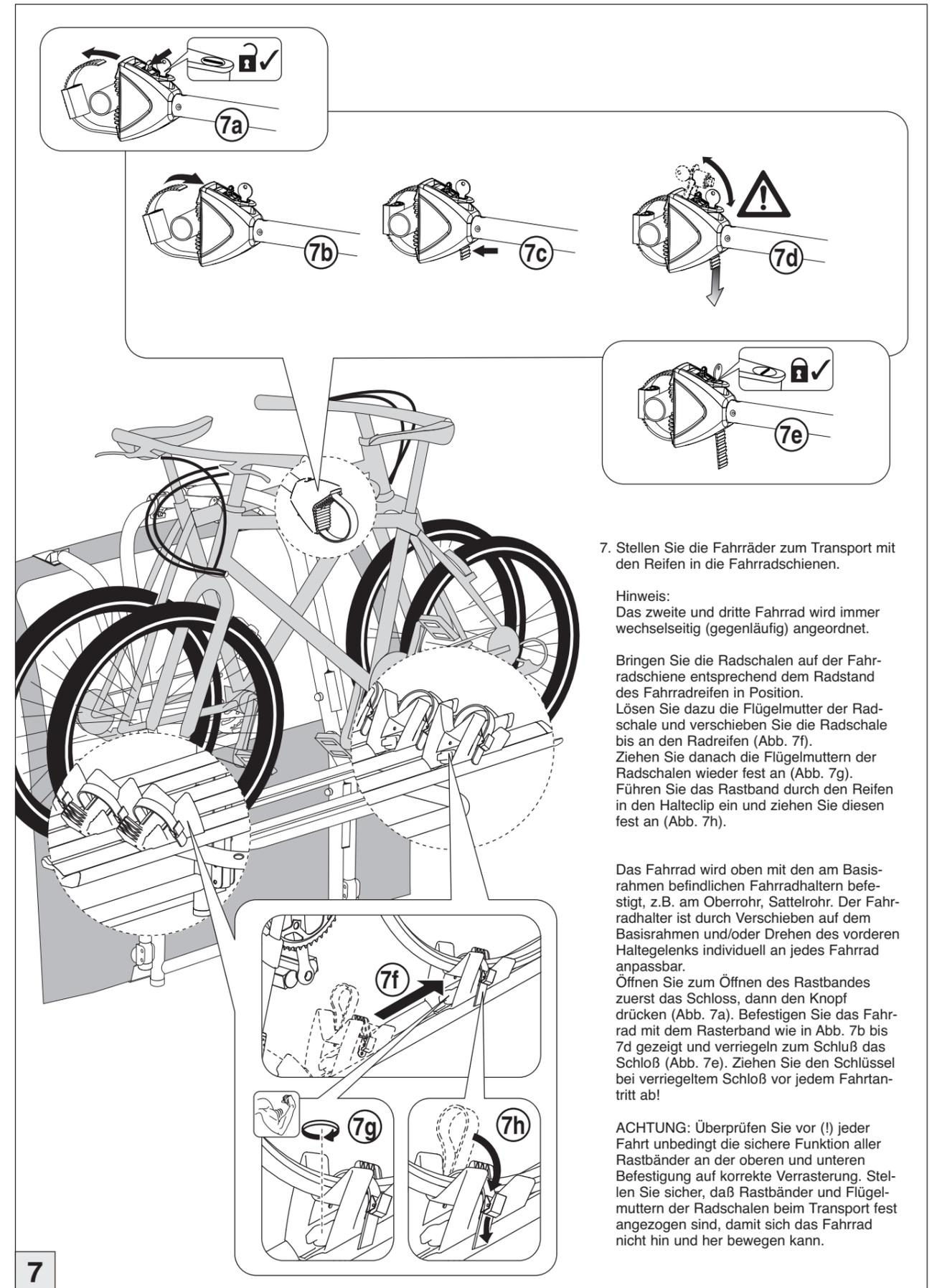
7. Stellen Sie die Fahrräder zum Transport mit den Reifen in die Fahrradschienen.
