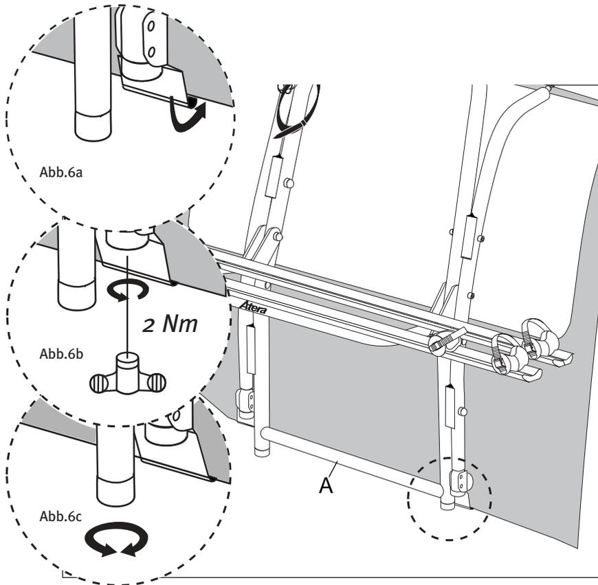
6. Untere Haltekralle mit dem Vielzahnschlüssel öffnen. Heckklappe leicht öffnen und untere Haltekralle am Falz der Heckklappenunterkante einhaken (Abb.6a).
